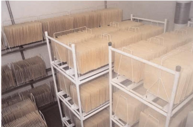
Jetzt sind die Platten gebacken und sehr zerbrechlich. Um dem entgegen zu wirken und um das Bohren der Hostien zu ermöglichen, müssen die Hostienplatten befeuchtet werden. Das geschieht in einem Feuchteraum wo die Hostienplatten in den Körbchen längere Zeit einer Luftfeuchtigkeit von 85-90% ausgesetzt werden.
