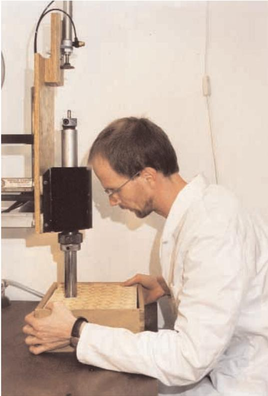
dabei aus und diese Hostien müssen hinterher, wie auch andere defekte Hostien aussortiert werden. Die ausgebohrten Hostien fallen in einen Korb unterhalb der Bohrmaschine. Die Hostien werden von Hand sortiert und abgepackt.
