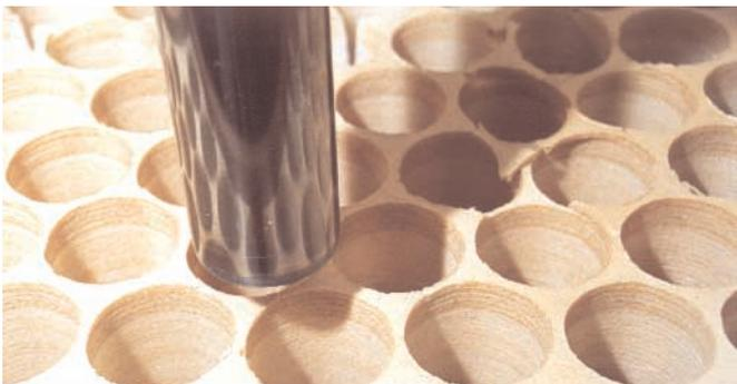
Danach werden die Hostien mit einem Edelstahlhohlbohrer aus den Platten gebohrt. Für jeden Durchmesser gibt es einen anderen Bohraufsatz. Fünfzig Hostienplatten werden dazu in einem Rahmen aufeinander gestapelt und zusammen ausgebohrt. Die letzte Hostienplatte bricht
